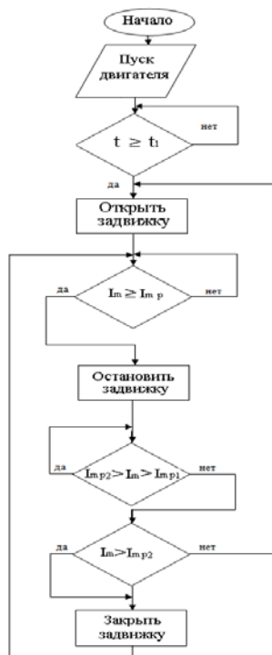
Рисунок 8 – Алгоритм работы автоматической системы регулирования положения шибера задвижки
