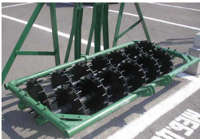
Фиг. 3. Каток кольчато-шпоровый типа ЗККШ-6М
